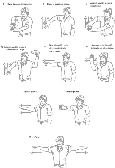
CÓDIGO DE SEÑALES DE MANIOBRA PARA GRÚAS AUTOPROPULSADAS
